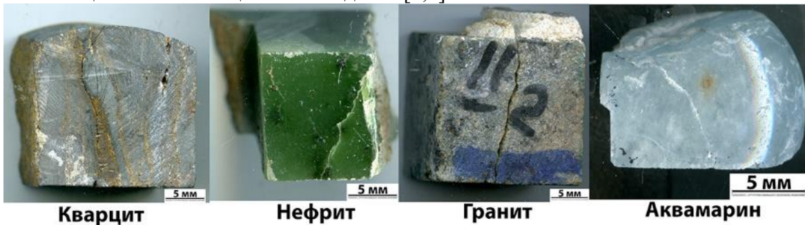
Рисунок 1. Образцы горных пород (кварцит, нефрит, гранит, аквамарин) с трещинами, возникшими при взрывном воздействии.
