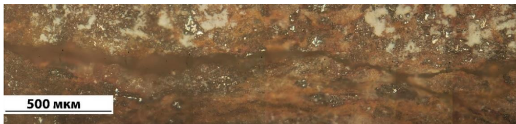
Рисунок 1. Образцы горных пород (кварцит, нефрит, гранит, аквамарин) с трещинами, возникшими при взрывном воздействии.
